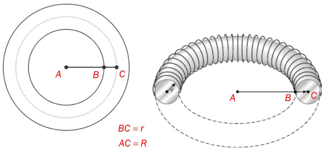
Bildet ovenfor viser en torus. Torusen er laget av et aluminiumsrør. Figurene viser tverrsnitt av torusen.
